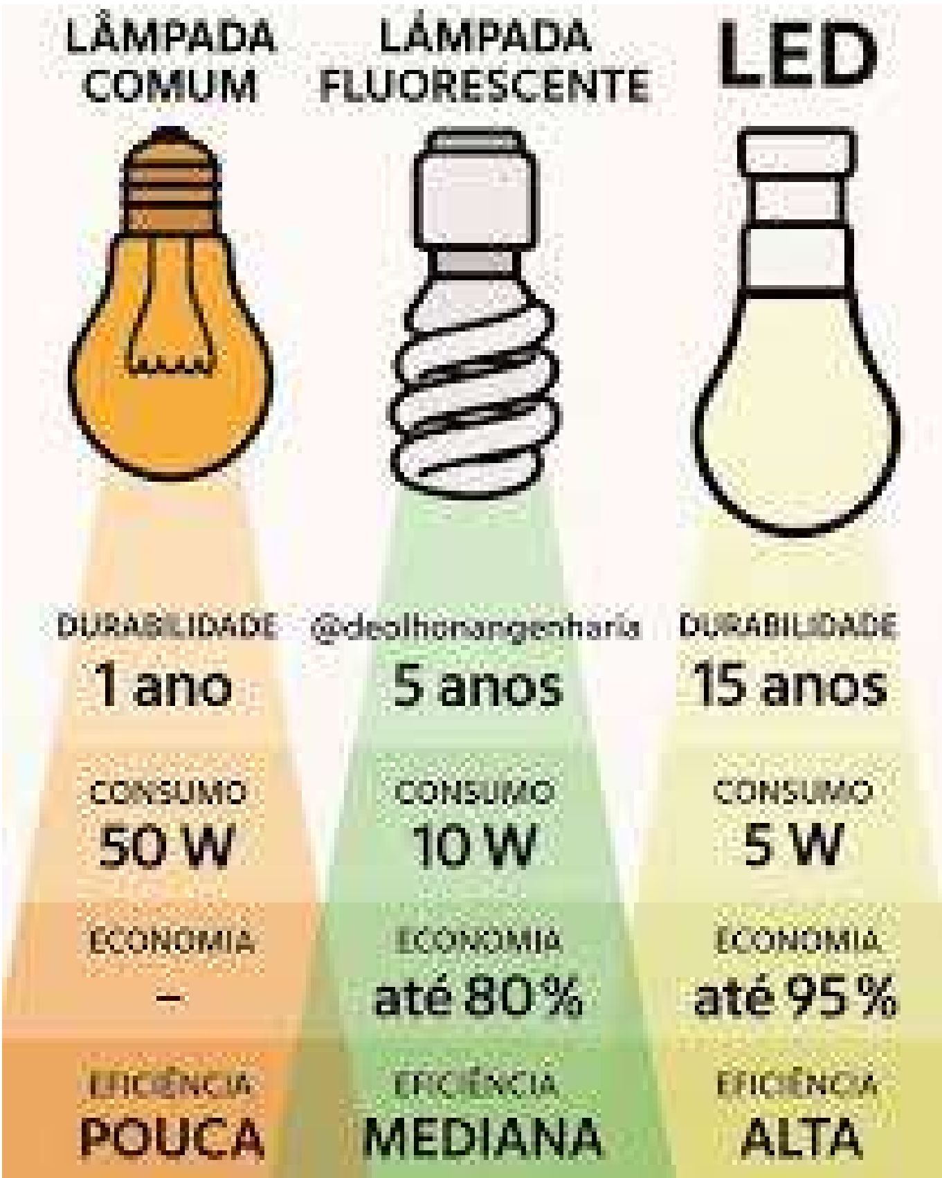
Figura 7: Comparação dos tipos de lâmpadas
