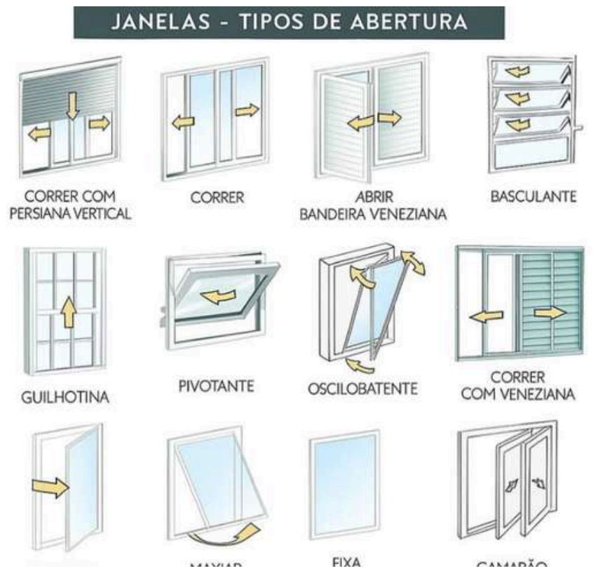
Figura 13: Exemplificação de classificações de aberturas laterais.
