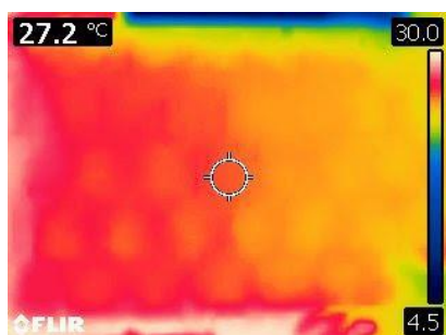
Figura 36. Medição oposta azulejo de 6mm.
