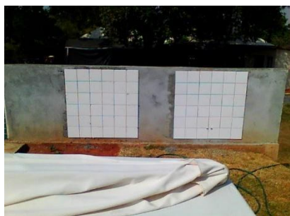
Figura 1. Azulejos sobre muro foto tirada com câmera termográfica Flir. Os da esquerda possuem 6mm e os da direita possuem 3mm.
