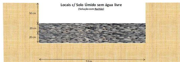
Figura 4. Seção tipo da camada de Rachão.
