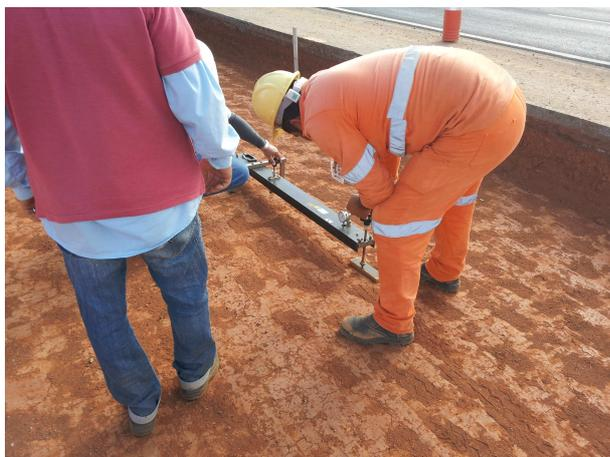
Figura 14 – Ensaio com a viga Benkelman.
