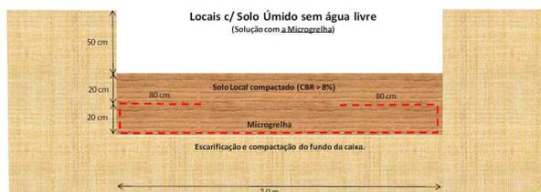
Figura 10 – Seção tipo da solução com microgrelha.
