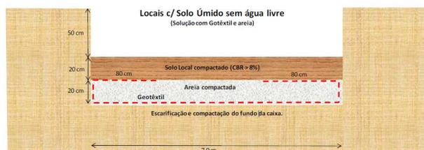
Figura 8 – Seção tipo da solução com Geotêxtil.
