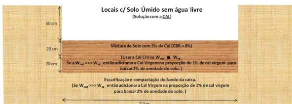
Figura 12 – Seção tipo da solução com a Cal.
