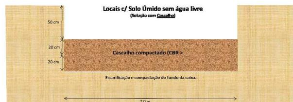
Figura 6 – Seção tipo da solução com cascalho.
