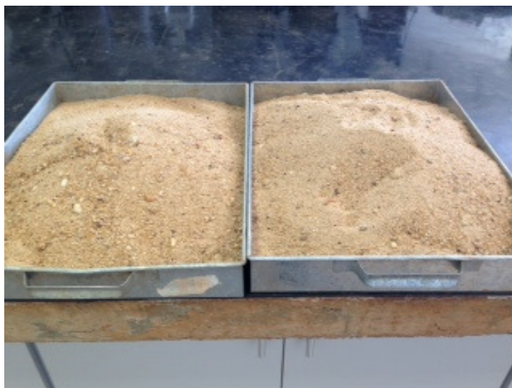
Figura 8 – Agregado normal miúdo e do concreto na betoneira.
