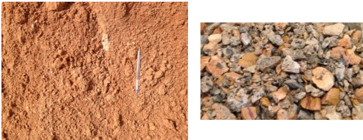
Figura 4 – Aspecto dos agregados miúdos e graúdos para uso no laboratório.
