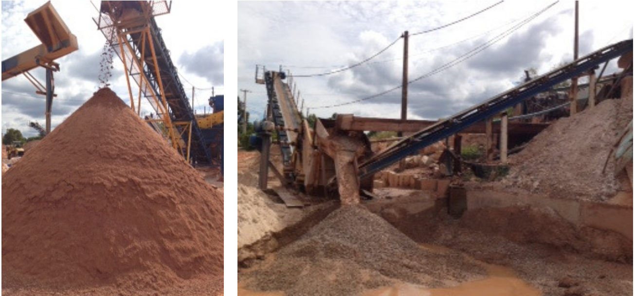
Figura 2 - Areia fina e RCD granulometricamente maiores prontos para serem estocados.
