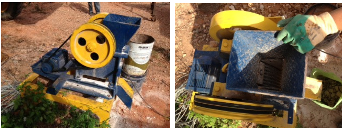
Figura 3 - Britador de mandíbulas para realização da britagem secundária.
