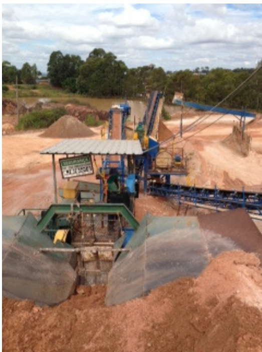
Figura 1 - Britador de mandíbulas e esteira com camada magnética.
