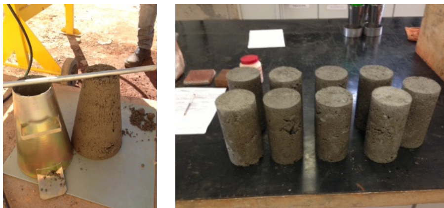
Figura 9 – Abatimento do concreto com agregados normais e aspecto dos corpos-de-prova com teor de A/C de 0,4.
