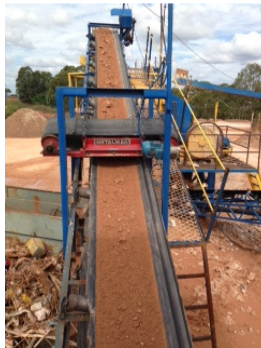
Figura 1 - Britador de mandíbulas e esteira com camada magnética.
