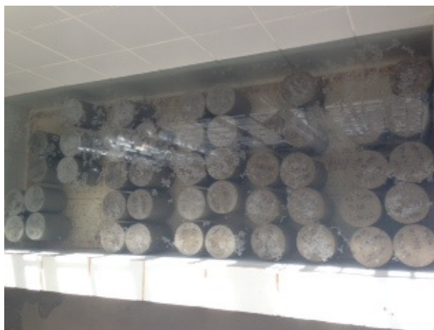
Figura 11 – Tanque de armazenamento dos corpos-de-prova inertes em água para o processo de cura
