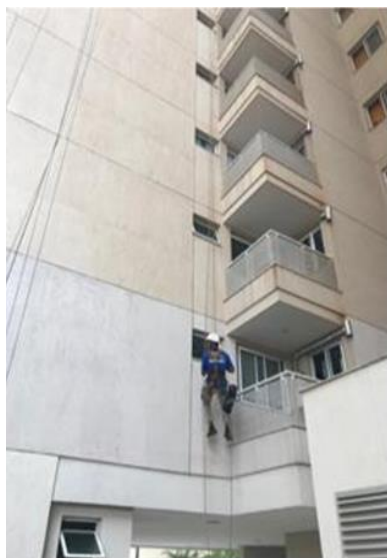
Figura 43 Ensaio de percussão realizado nas fachadas Figura 44 Regiões soltas nas requadrações
