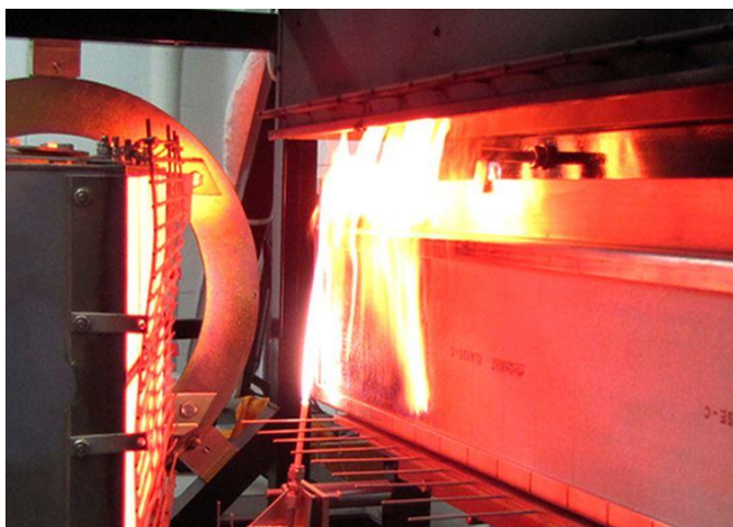
Figura 1 - Ensaio de propagação superficial de chama em material de revestimento naval
