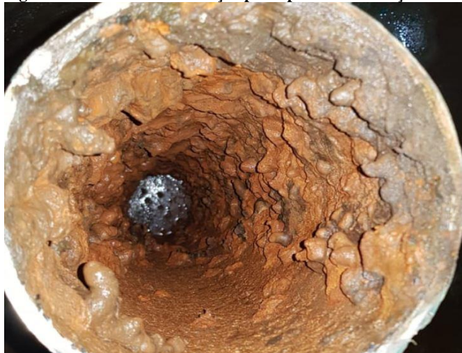
Figura 5 – Amostra da tubulação principal de alimentação da rede de SPK/Hidrantes
