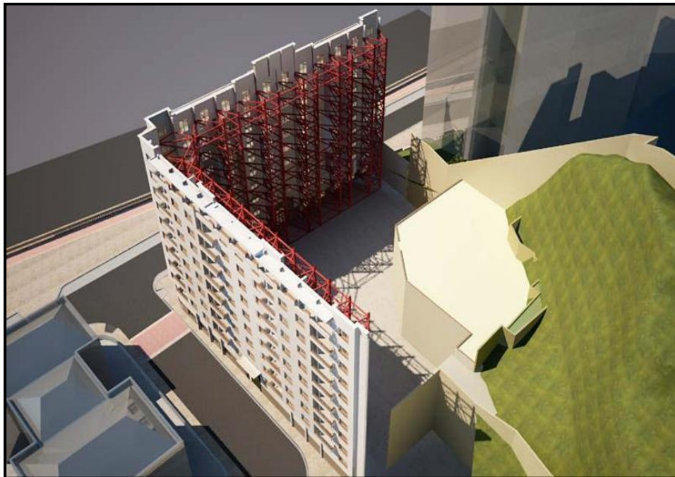
Figura 12 - Detalhamento da maquete de conservação das fachadas
