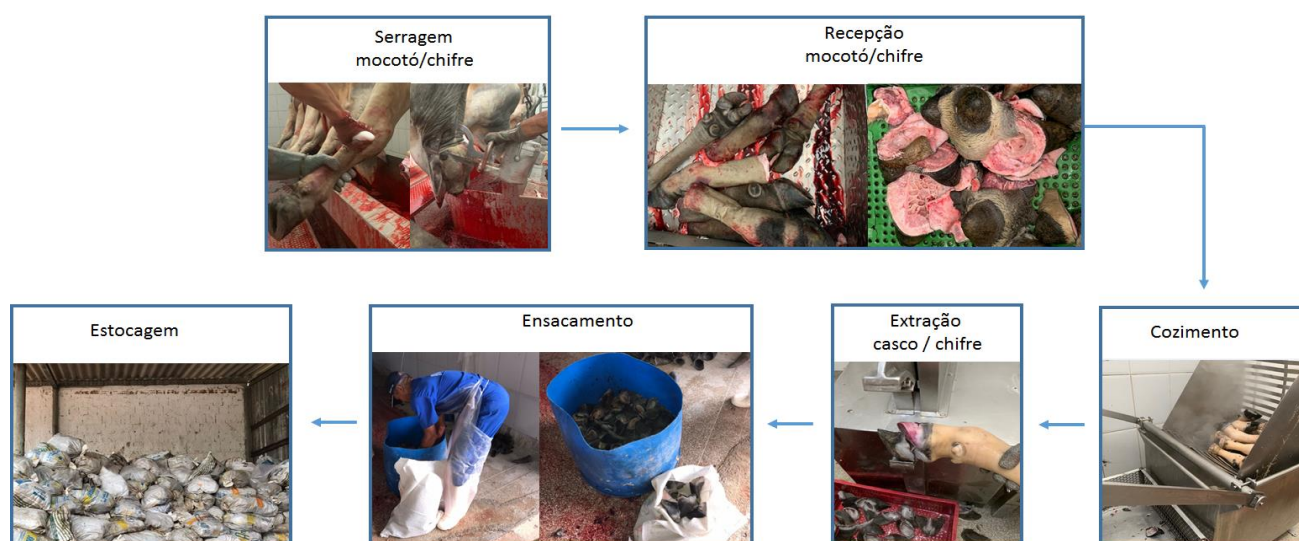
Figura 08 - Fluxograma do processamento industrial para obtenção de casco e chifre no abatedouro.
