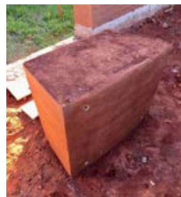
Figura 81 - Teste parede de taipa
